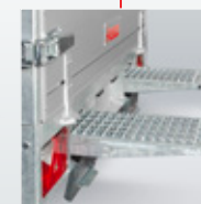
Ramper, oppbevart under lasteplanet
