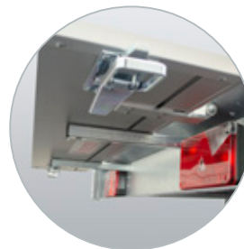
Uttrekkbare bjelker til støtte av baklem
